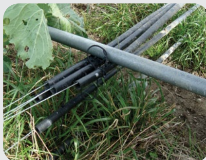
Ensamblaje de la rueda del irrigador a la mitad de la línea de la cerca con la barra deflectora de la cerca del irrigador sujetando la línea de la cerca hacia abajo.
