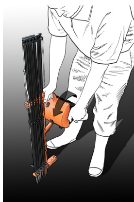
STEG 1 Lossa låsmutter (motsols).
