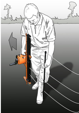
SCHRITT 4 Zwischenpfosten nach Bedarf setzen. Wenn ein Eckpfahl gesetzt wird, benutzen Sie eine Spannschnur, um den Pfahl zu fixieren (4a). SCHRITT 4a
