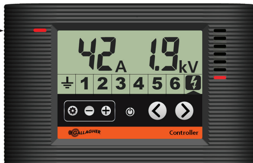
Controlador mostrando el Energizador en alarma de voltaje de salida
