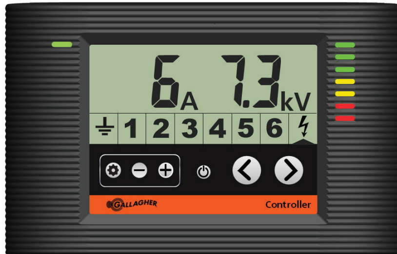
Controlador mostrando que el Energizador funciona normalmente
