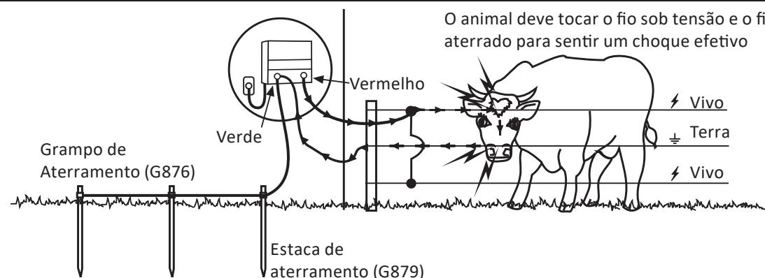
Estacas de aterramento de pelo menos 2 m (6 ft) de comprimento devem ser espaçadas em 3 m (10 ft). Use no mínimo 3 estacas de aterramento para M600, M700, M1200.
