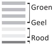
Deze LED-staafdiagram licht op bij iedere puls. Elk segment geeft een indicatie van de afrasteringsspanning. Een aflezing dient als volgt te worden geïnterpreteerd:
