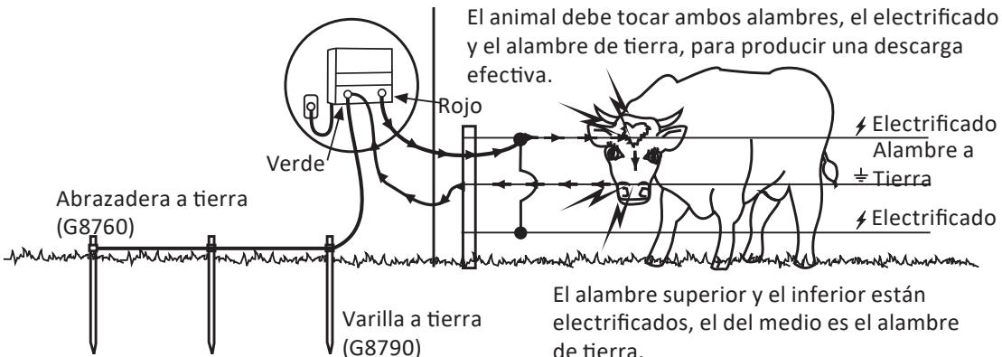
Las varillas de toma de tierra, de no menos de 2m (61/2 pies) de largo, deberán estar separadas a 3m (10pies) una de otra. Utilice un mínimo de 3 varillas de tierra para el M600, M700, M1200.
