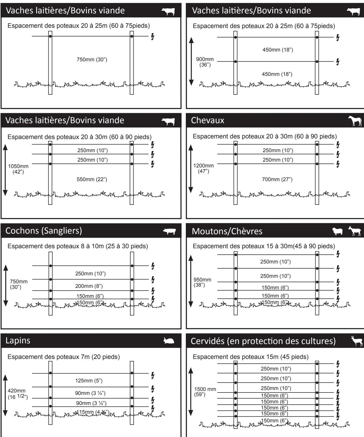
Pour l'espacement des fils et des poteaux en zone sèche avec de mauvaises conditions de mise à la terre, consultez votre distributeur Gallagher.
