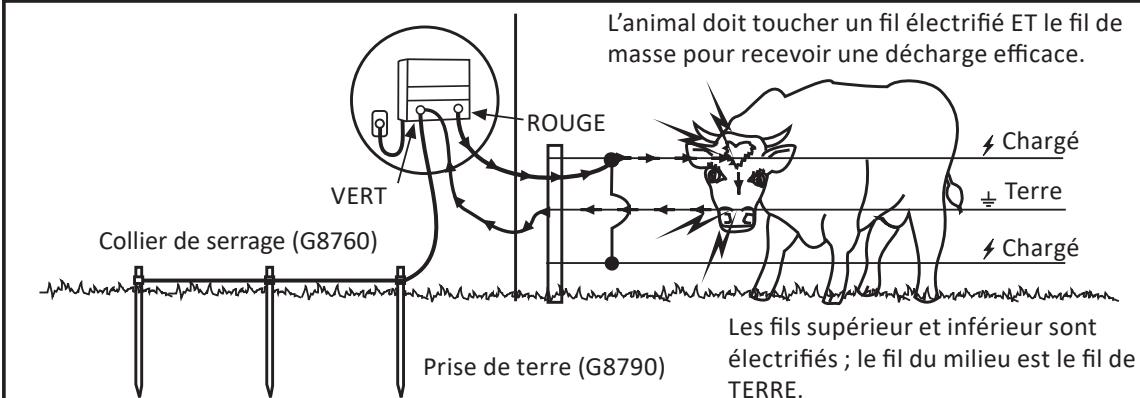
Des prises de terre, d'une longueur minimale de 2 mètres, doivent être enfoncées dans le sol avec un écartement d'au moins 3 mètres. Utilisez au minimum 3 tiges de terre pour le M600, M700, M1200.
