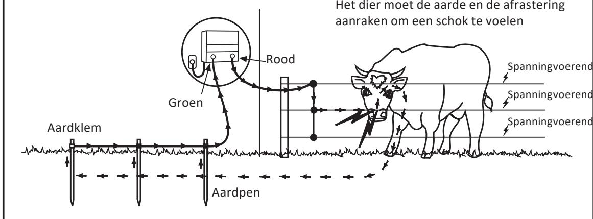
Aardingspennen, tenminste van 2 meter lang, moeten 3 meter van elkaar verwijderd in de grond geplaatst worden. Gebruik minimaal 3 aardingspennen voor de M600, M700, M1200.
