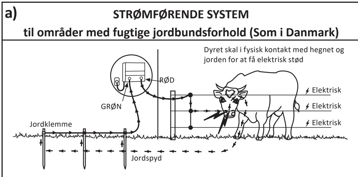
Jordspyd som er mindst 2 m lange bør placeres med 3 meters afstand fra hinanden. Benyt minimum 3 jordspyd til M600, M700 og M1200 spændingsgiveren.
