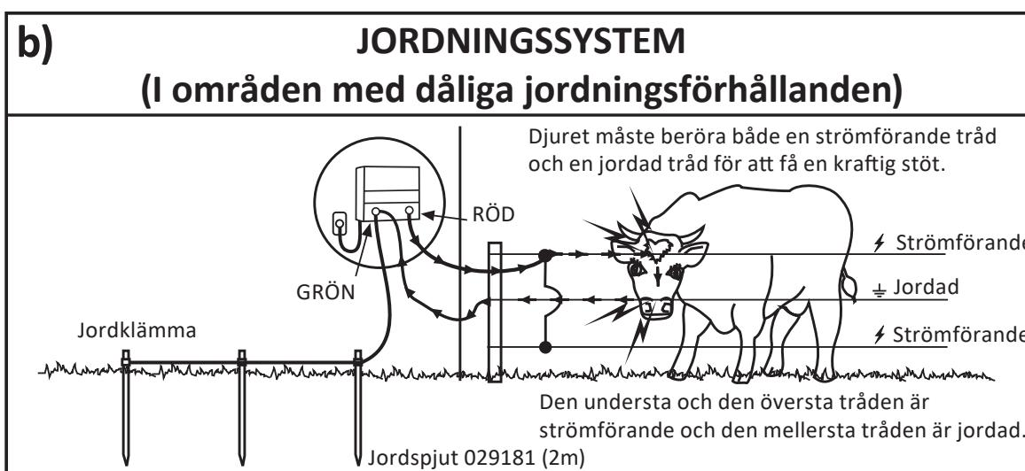
Minst en meter långa jordspjut bör fördelas med ett mellanrum på 3 meter. Använd ett minimum av 3 jordspjut till M600, M700, M1200.
