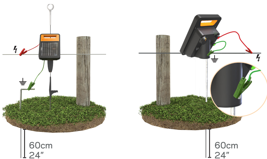
Puesta a tierra para el Paso 3 (a. b. c.)
