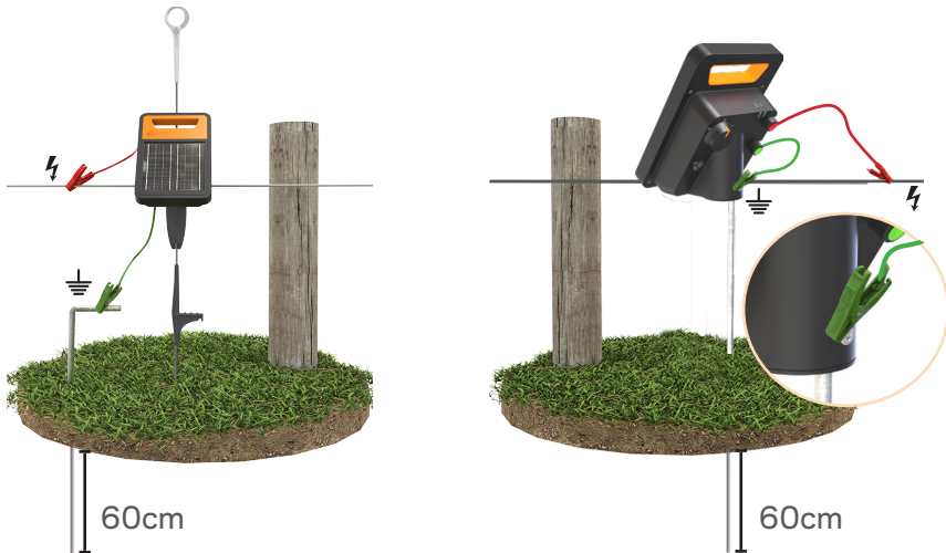
Erdung für Schritt 3 (a. b. c.)
