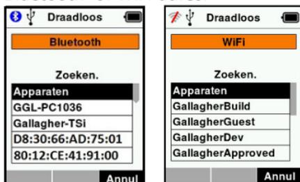
Gebruik de pijltoetsen om een apparaat te selecteren om verbinding mee te krijgen en druk op de knop OK. De verbindingstatus verandert in **Koppelen...**
