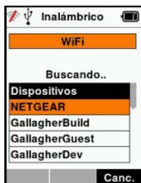
5. Utilice las teclas de flecha para seleccionar un dispositivo al cual conectarse y pulse el botón **OK**. El estado de conexión cambiará a **Intentando conect...** (Intentando conectarse).
