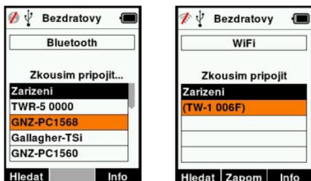
**Poznámka:** Čtečka HR4 může být nastavena na posílání a/nebo příjem dat z jiných zařízení přes Bluetooth a WiFi.
