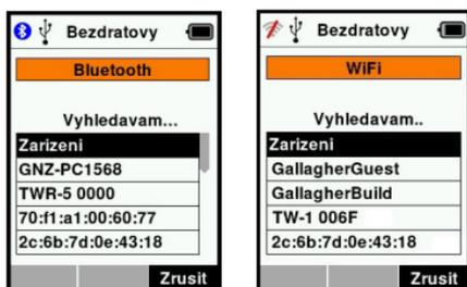
5. Použijte šipky a vyberte zařízení, ke kterému se chcete připojit a stiskněte **OK**. Status připojení se změní na **Pokouším se připojit...**
