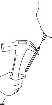
**Importante:** No ponga las orejetas del martillo o los alicates sobre el cable galvanizado expuesto ya que dañará el alambre y causará corrosión.
