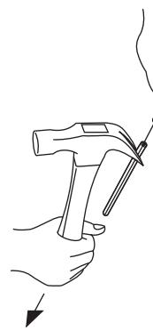
**Importante:** Cercare di non graffiare il filo galvanizzato con il martello o con le pinze Maun facendo attenzione a non rovinare il rivestimento di zinco e ridurre la resistenza alla corrosione.
